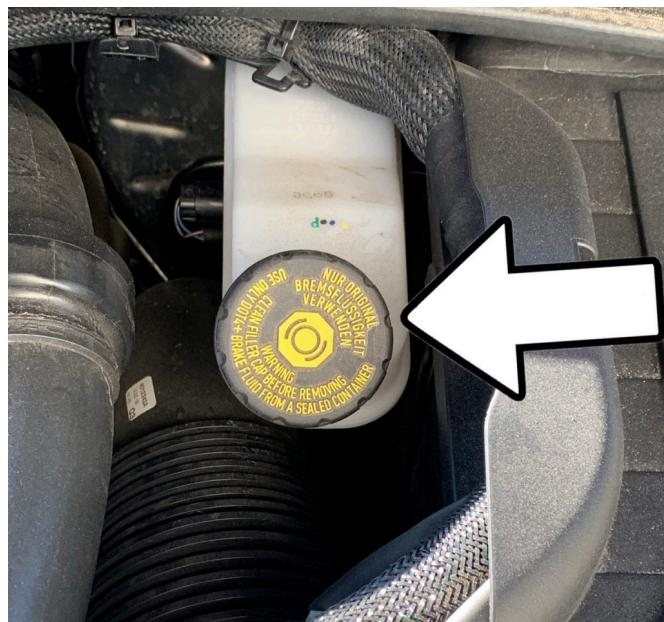
Quelle est la conséquence d'un niveau insuffisant du liquide de frein ? **Une perte d'efficacité du freinage.**
