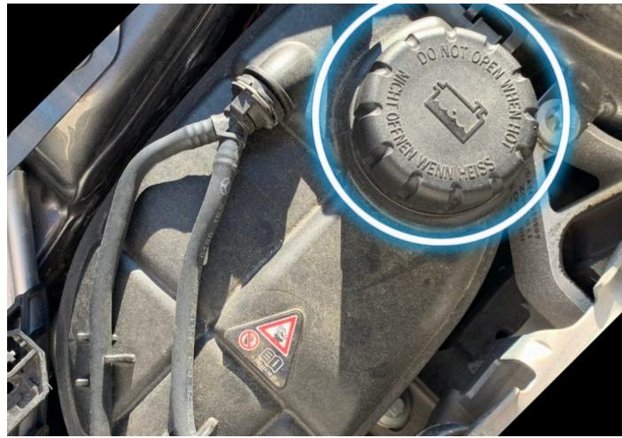
Quel est le danger si l'on complète le niveau du liquide lorsque le moteur est chaud ? **Un risque de brûlure.**
