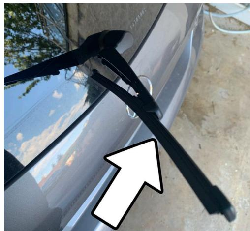
Quel est le risque de circuler avec des balais d'essuie-glaces défectueux ? **D'avoir une mauvaise visibilité en cas d'intempéries. ( des essuie-glaces usagés laissent des traces sur le pare-brise.**
